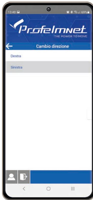
Modificare la direzione del motore, apertura verso sinistra o destra, e del fine corsa a seconda dell'installazione.
