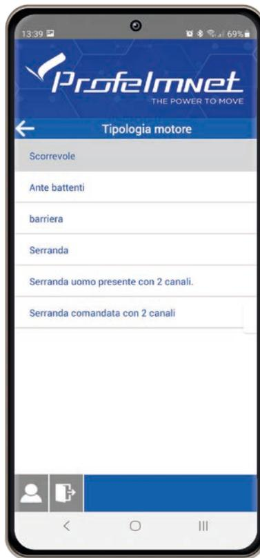
Scelgo la tipologia di motore che ho nell'installazione
