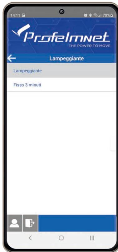
**LAMPEGGIANTE:** Il lampeggiante lampeggia per tutta la corsa del motore.
