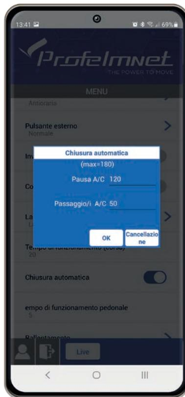
Tempo di Pausa, chiusura automatica (Il tempo di apertura della porta se il raggio della fotocellula non viene interrotto)
