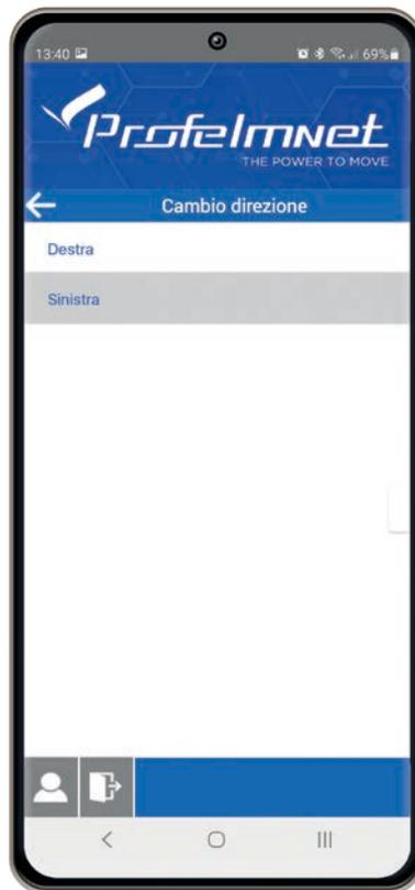
Modificare la direzione del motore e dei fine corsa seconda dell'installazione.
